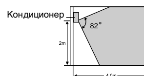
Высота установки кондиционера более 2 м
