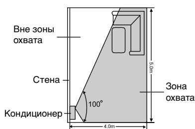
Кондиционер установлен в левой стороне комнаты
